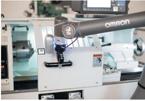
Совместные, или, как их принято называть, коллаборативные, роботы более компактны, чем обычные роботы, и часто имеют легкие рамы с мягкими закругленными краями и минимизированными точками возможного защемления (рис. 2). Они оснащены датчиками, определяющими момент, когда человек входит в общее для совместной работы пространство, а также когда с ним установлен прямой контакт. Но при
