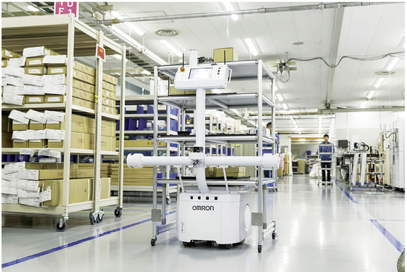
Рис. 1. Автономные мобильные роботы могут самостоятельно перемещаться по объекту с помощью встроенного программного обеспечения для ориентации в пространстве на данной местности. Изображения предоставлены компанией Omron Automation Americas
