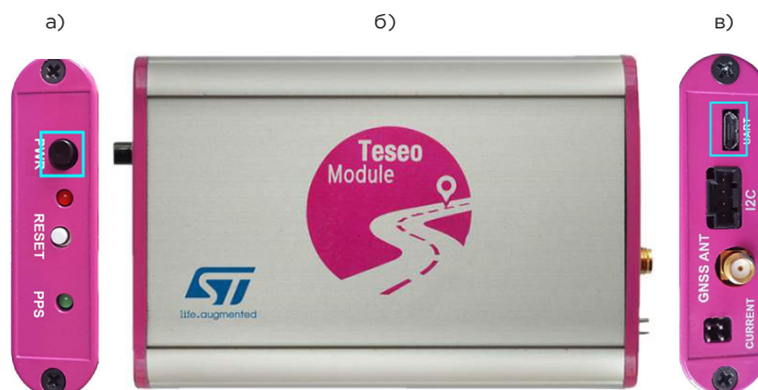
Рис. 8. Внешний вид ГНСС-модема EVB-LIV3F а) задняя торцевая панель: индикаторные светодиоды и кнопки включения питания и перезапуска модема; б) вид сверху; в) передняя торцевая панель — интерфейсы модема
