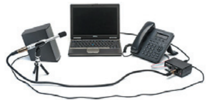
Рис. 6. Комплект автоматической настройки MiTuner ZLE38470BADA
