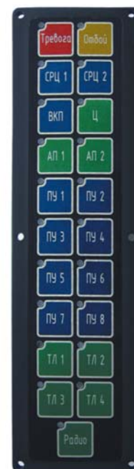
● Рис. 5. Внешний вид пьезоклавиатуры, изготовленной ООО «Николь»
