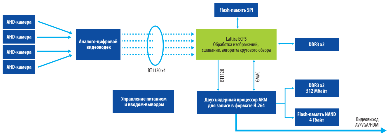
Рис. Блок-схема системы кругового обзора на базе микросхемы ECP5
