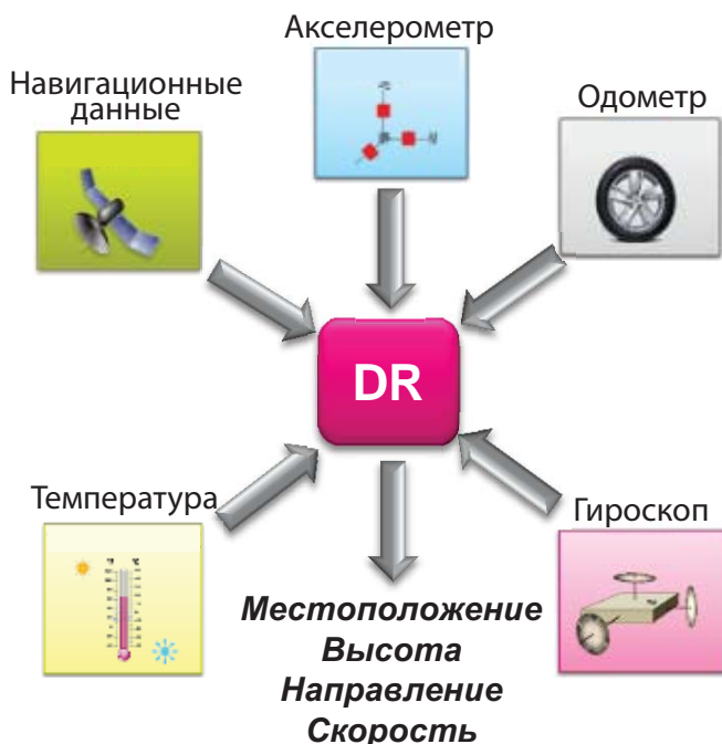
Рис. 4. Функционал системы Dead Reckoning
